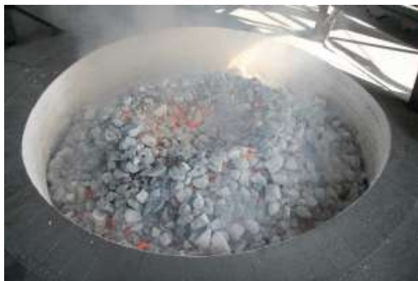
土中炉による塩焼き生石灰製造風景:村樫石灰工業株式会社御提供
